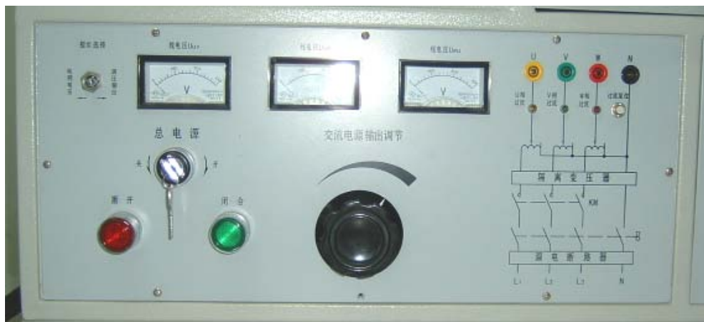
图 2 (a) MCL 系列教学实验台主控制屏供电部分
