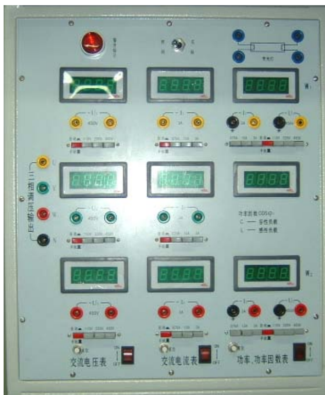
图 2 (b) MCL 系列教学实验台主控制屏仪表部分
