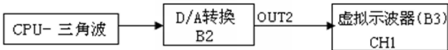
图1-1 数/模转换实验框图
